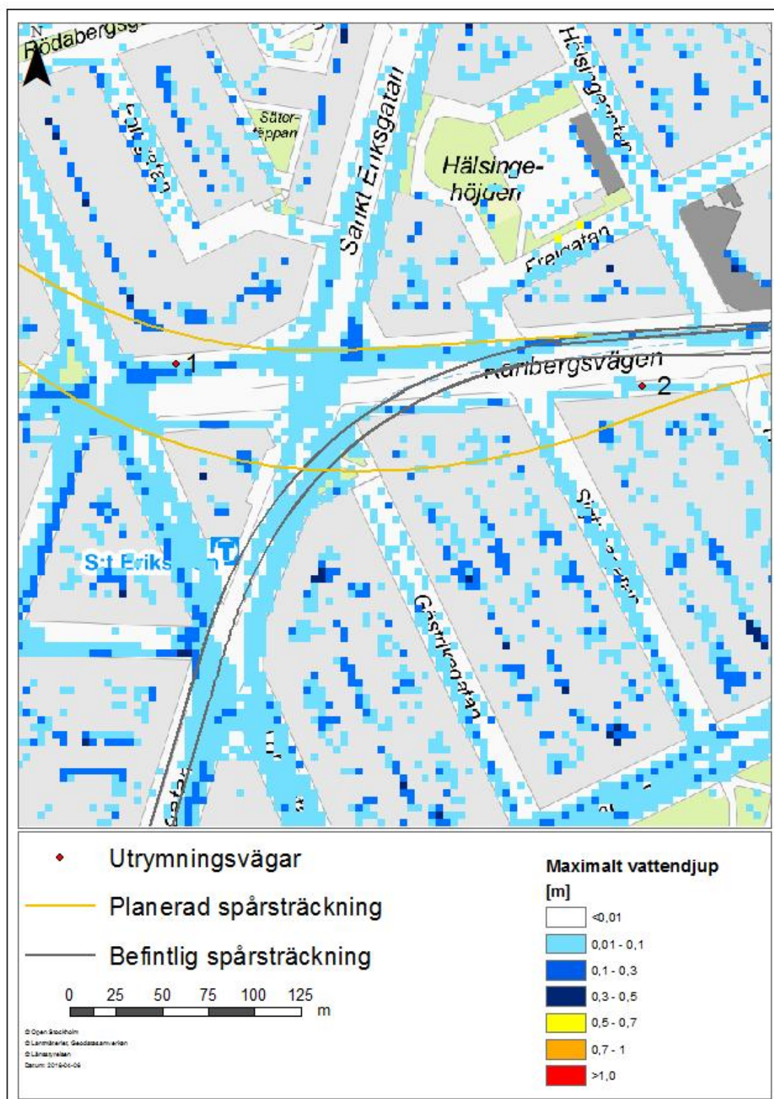
Figur 2. I Figuren visas objekt 1-2 och maximalt vattendjup under simuleringen i respektive beräkningscell.
