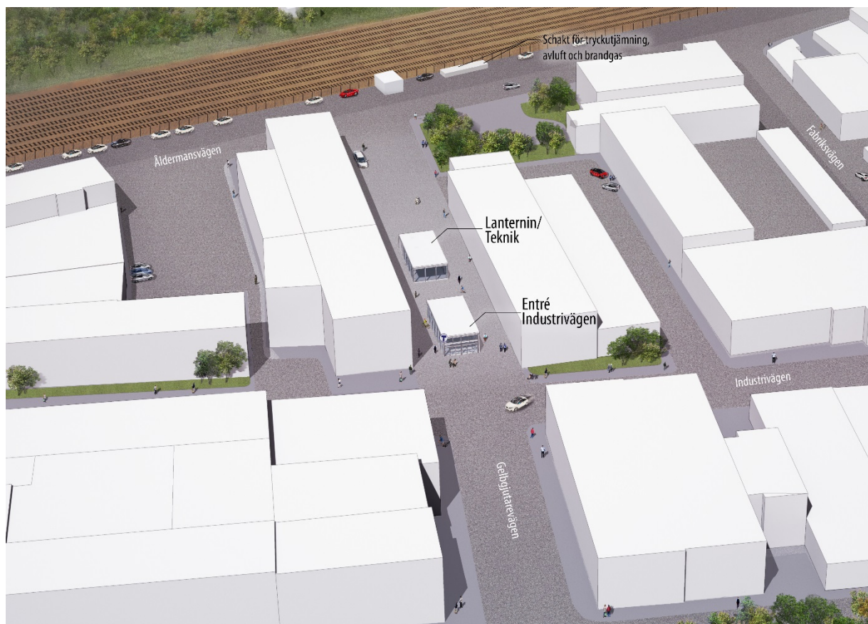
Figur 44. Entré Industrivägen och schakt för tryckutjämning, avluft och brandgas vid Station Hagalunds industriområde.
