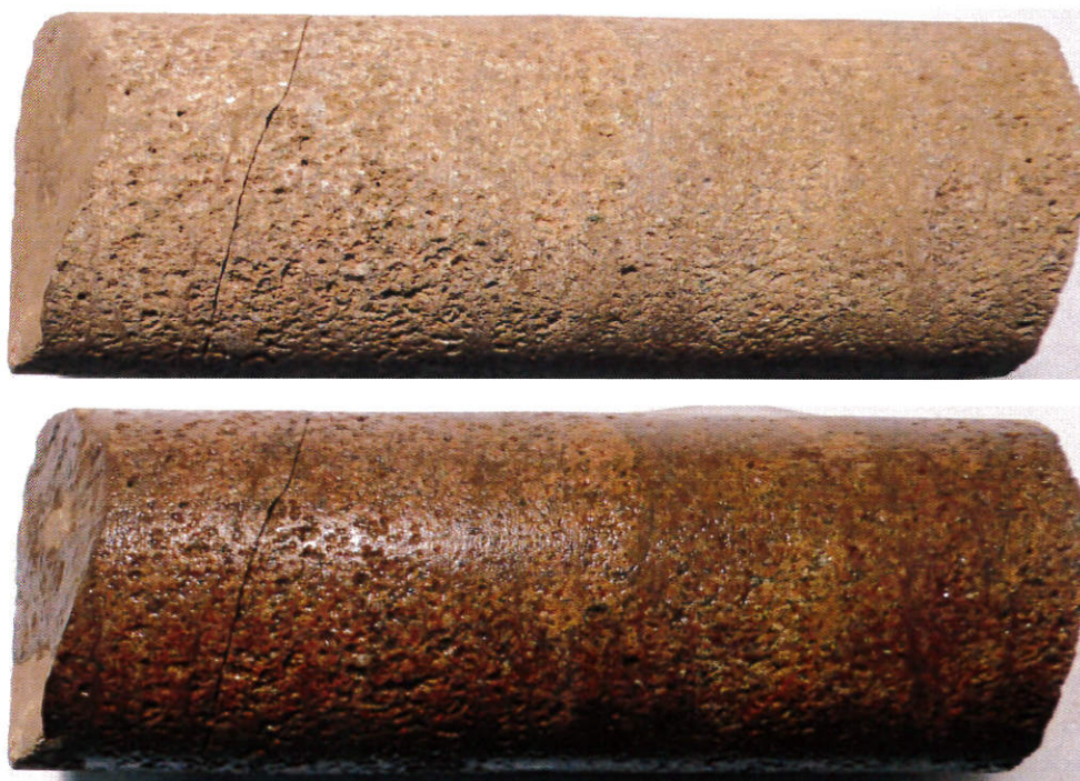
Figur 1. Undersökt borrkärna i torrt (överst) och fuktigt (nederst) tillstånd. Kärnans totallängd är ca 13 cm. Notera större spricka till vänster som delar kärnan i en mindre och större del.
