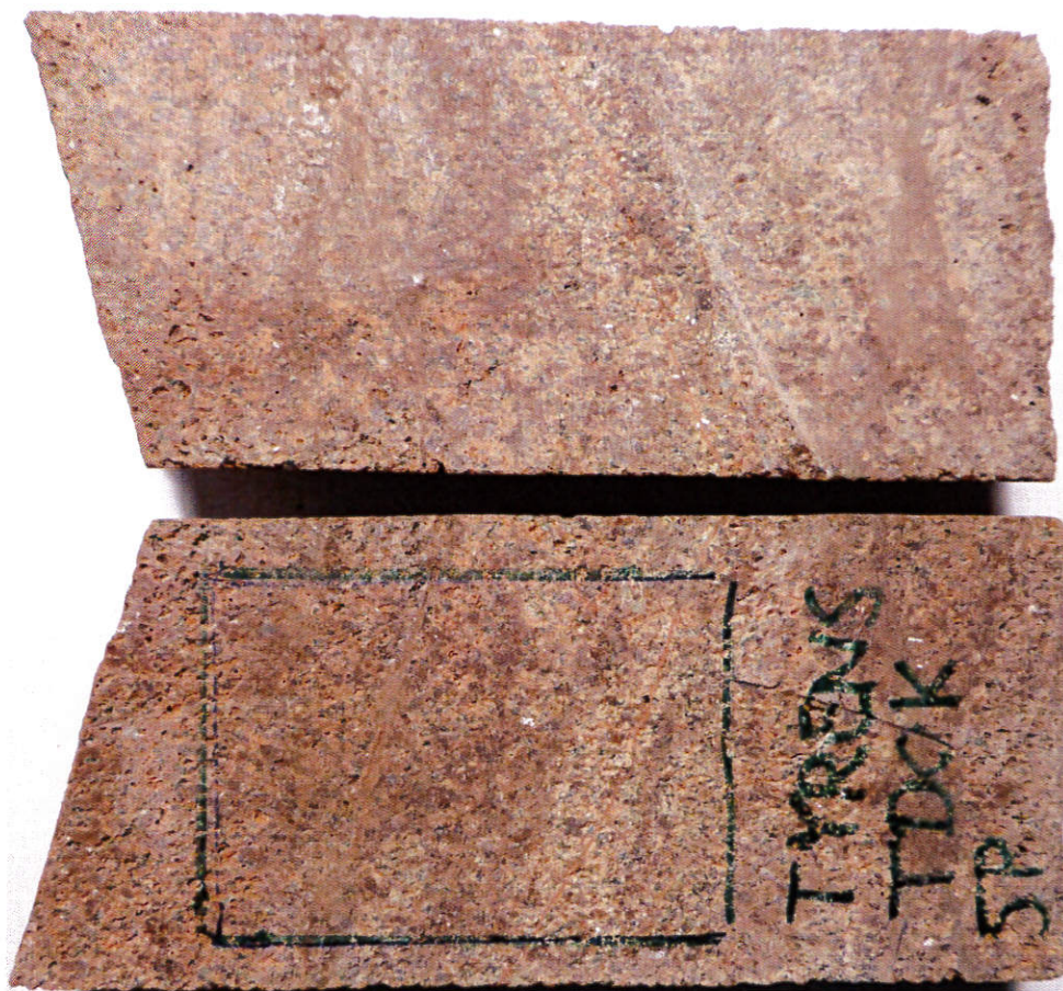
Figur 2. Den större delen av undersökt borrkärna i Figur 1, sågad i två halvcylindrar i axelns längdriktning. Notera tegelröd tunn och distinkt spricka som korsar kärnans centrala del och mer diffusa sprickor/strukturer i vänstra och högra delen. Den gröna rutan markerar plats för tunnslip.
