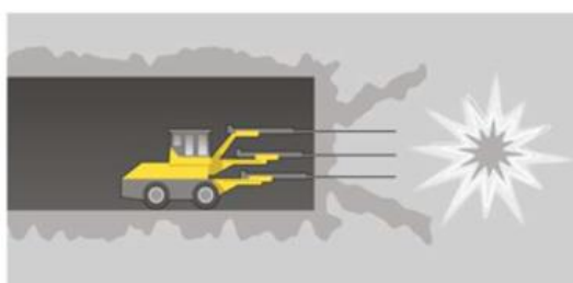
Salvborrning, laddning och sprängning: 1-5 meter långa hål borrar i tunneln och laddas med sprängämne. Sprängningsarbetena anpassas med hänsyn till risker för skador till följd av vibrationer.
