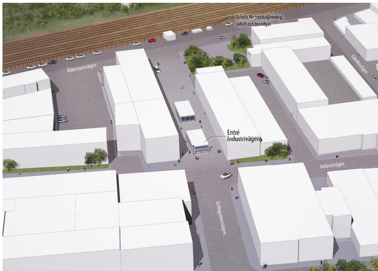
Figur 45. Entré Industrivägen och schakt för tryckutjämning, avluft och brandgas vid Station Hagalunds industriområde.
