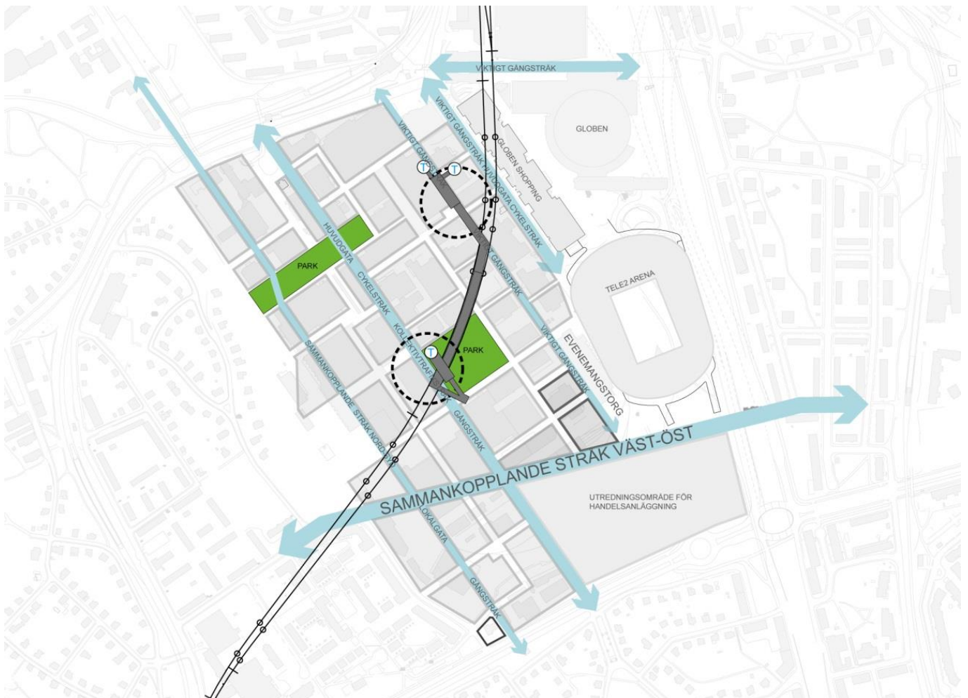
Figur 5.3 Alternativ Svart och förslag på plattformslägen (grå) och uppgångar (T).
