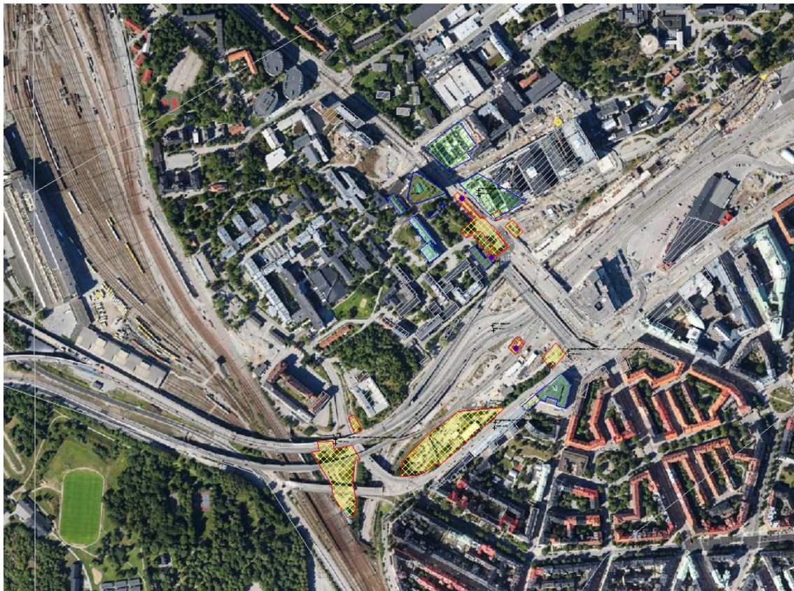
Figur 3 Översikt över byggarbetsplatser vid station Hagastaden (gula områden). Spontningsmaskiner är markerade med blå punkter.
