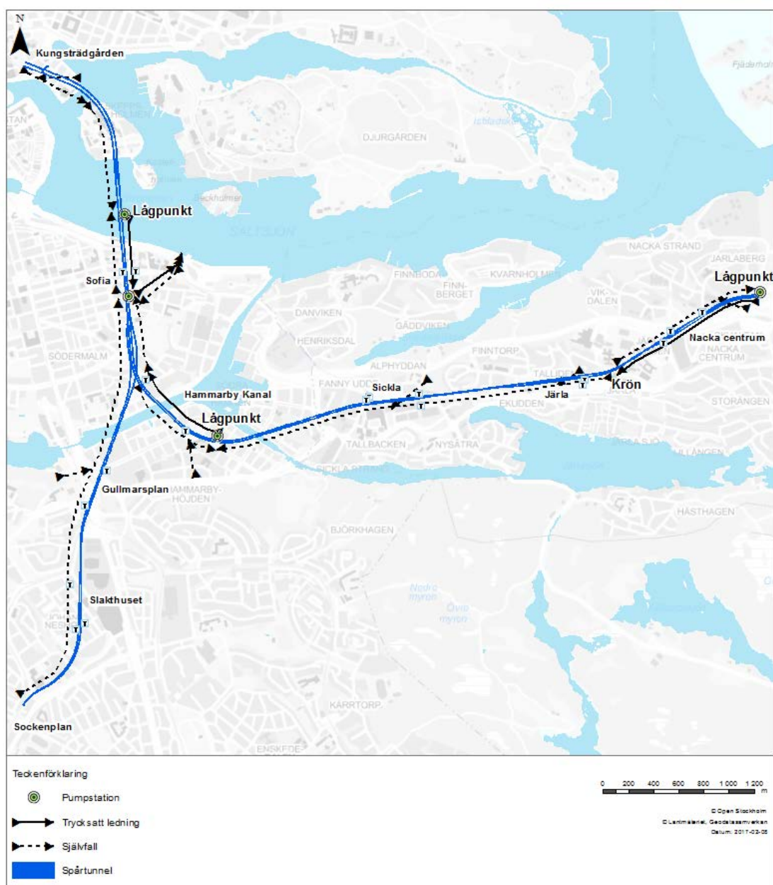
Figur 38. Kartillustration som översiktligt visar dräneringsvattnets flödesväg genom självfall eller trycksatta ledningar samt pumpstationernas placering i plan.
