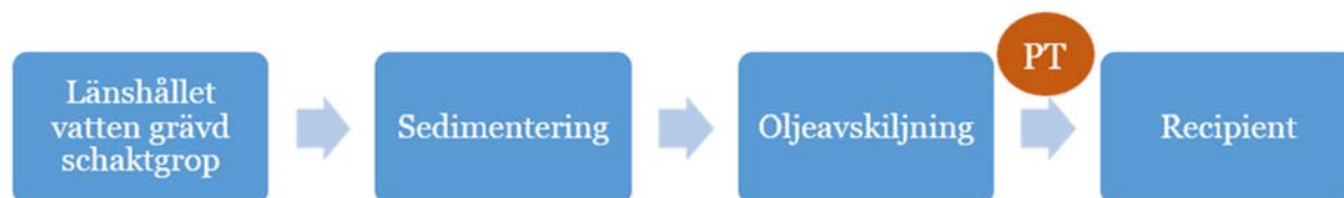
Figur 37. Länshållet vatten från schaktgrop, utan sprängning, PT = provtagning
