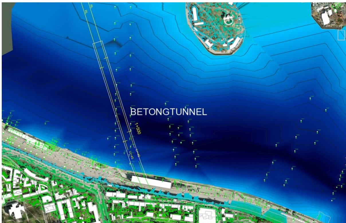
Alternativ 5B Passage av Saltsjön i sänktunnel. Geotekniska undersökningar och en övergång till bergtunnel framför Fotografiska Muséet.
