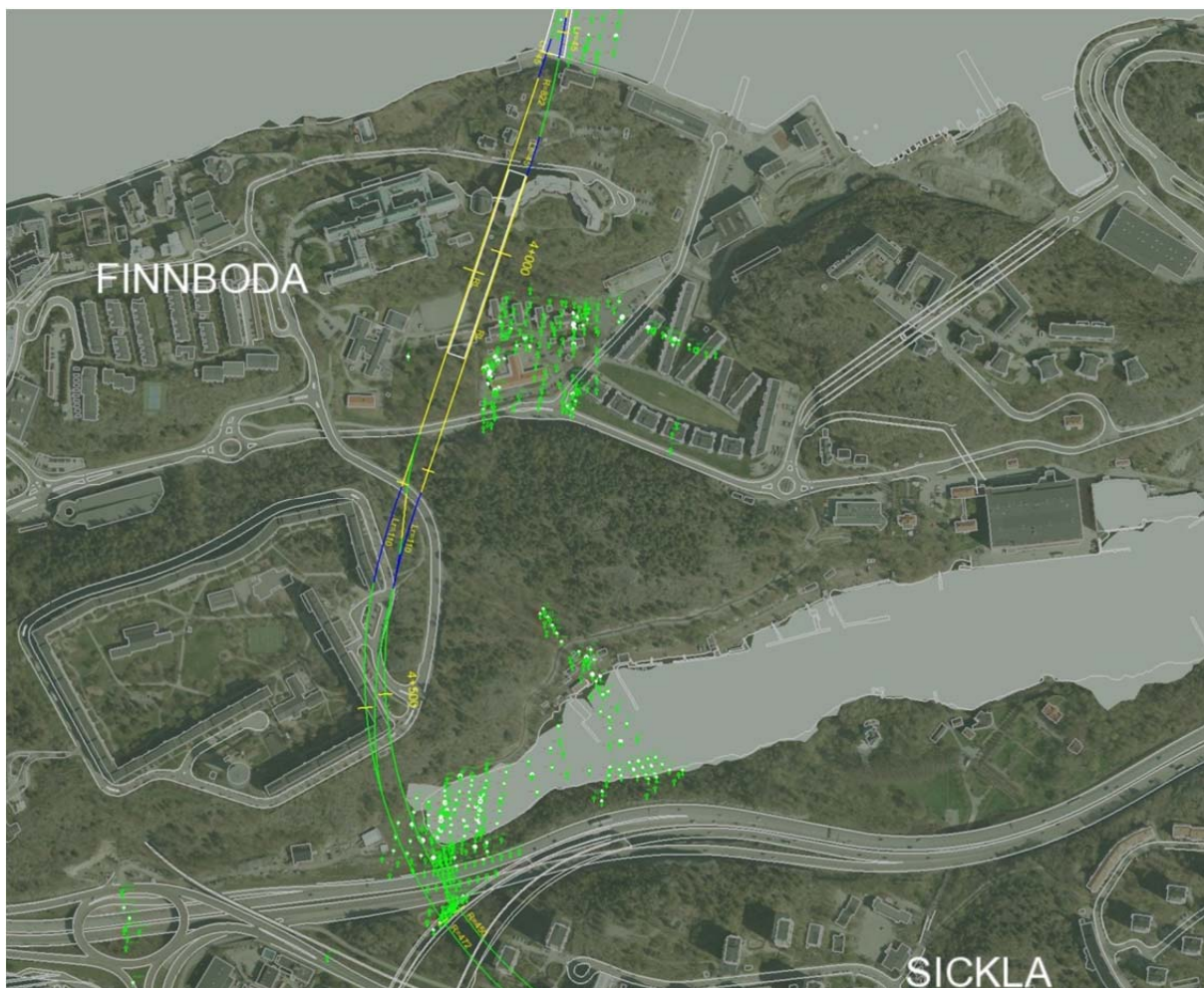
Alternativ 3 Undersökningar utförda av Trafikverket i bergsvackorna under Svindersviken och Finnboda.
